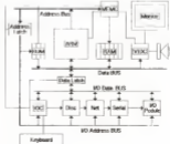
Figura 1. Schematica generale dello struttura hardware Archimedes di una macchina RISC OS. Si ritenga in particolare le connessioni. Per i quattro componenti dei chip-set con particolare riferimento al MEMC, al VDC e al IOC per i quali gestire la memoria disponibile.
